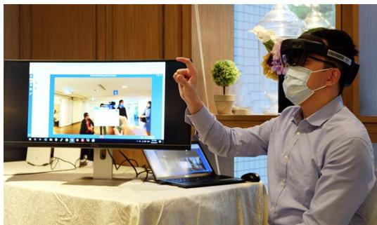
透过 AR 智能眼镜，从后台系统把实时讯息、故障排除记录、图像及加密数据，串流传送予前线工程师及系统维护人员。让现场工作的工程师可以同时处理多项任务，生产力跃升高达五成。
