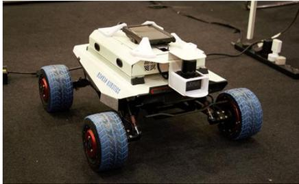
无限漫游者是一款用于室内巡逻的自动导航服务机器人。它的导航系统融合激光视觉可以进行点对点巡逻安排和检查，可以为客户度身订制机器人解决方案以满足不同场景及防疫协助需求。
