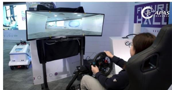
由汽车科技研发中心（APAS）研发，此应用建基于 5G 网络的优点，低时延和高速的传输率令驾驶者能够同时进行遥距驾驶，及实时收看高清的路面情况影片。驾驶者只需在模拟驾驶舱透过实时影片去进行操作，不受地域限制，同时又能享受真实的驾驶感。
